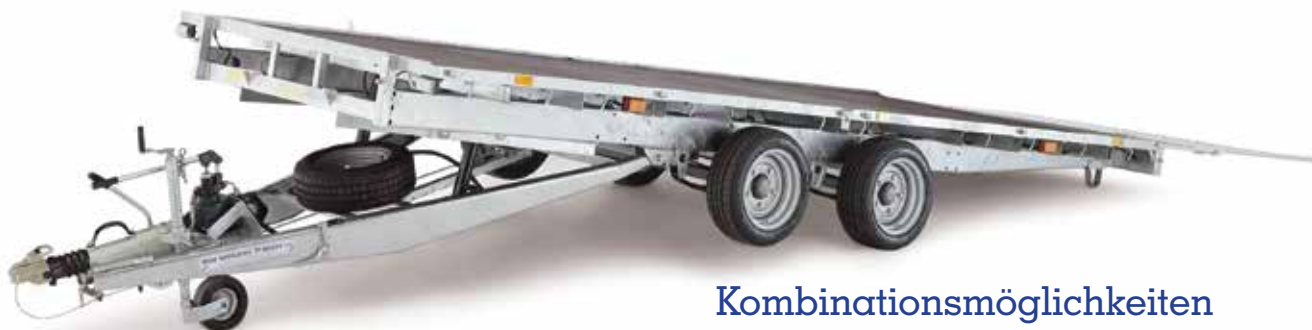
CT166 mit optionaler 0,91 m langer Laderampe (0,3 m Rampe ist Standard-Ausstattung)
