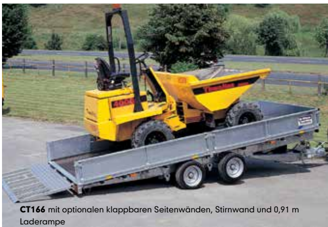
CT166 mit optionaler 0,91 m langer Laderampe (0,3 m Rampe ist Standard-Ausstattung)
